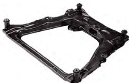
フロントサスペンションメンバー：車体を支える骨格。強さと軽さが求められる。
